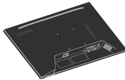
Schritt 4: Bringen Sie die Montagehalterung des VESA-Wandmontagesets (100 × 100 mm Lochabstand) mit den M4 x 10 mm VESA-Schrauben an.
